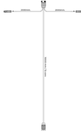
ZONE 2 - Hoofdkabel 10m incl. zij-kabel 15-aderig | 2x 15 PIN's Bajonet (Art. KS1-2660)
